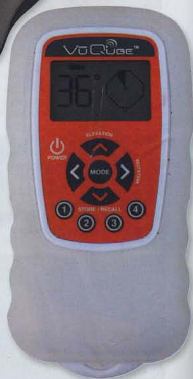
La télécommande affiche la valeur réelle de l'élévation ainsi que la position en azimut.
